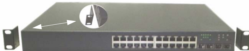
図 1-1 ブラケットの取り付け
